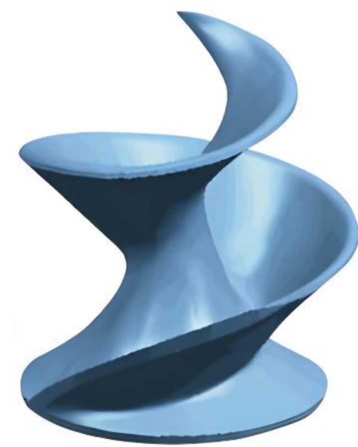
Рабочее колесо со спиральной и центробежной секциями
